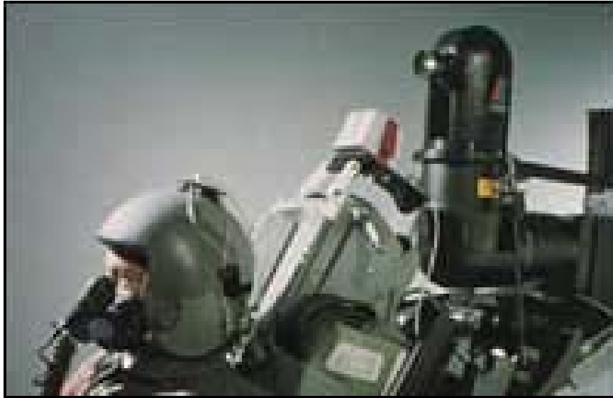
Gambar 2. VistaView Projector pada Full Mission Simulator ( http://www.es.com ).
