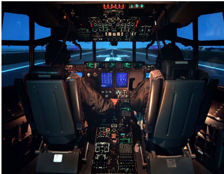
Gambar 4. Situasi dalam cockpit simulator modern. Perhatikan tampilan visual system di depan cockpit yang realistis sebagaimana aslinya.
